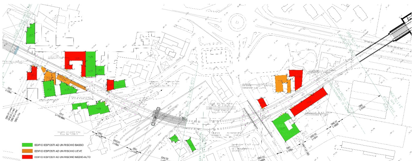
Figura 5. Planimetria tracciata con classificazione del rischio per i 19 fabbricati ricadenti nella fascia di interferenza.
